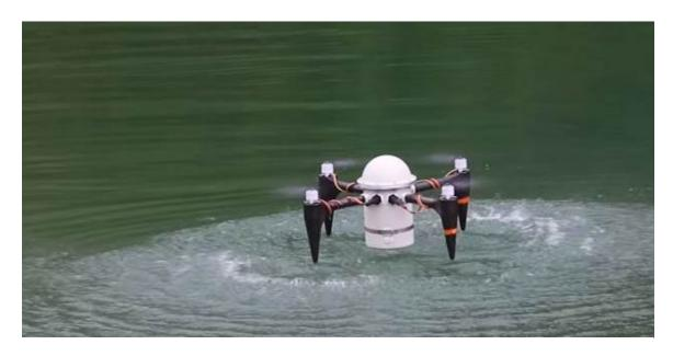
Los motores del CRANCUS están protegidos con material anti-corrosivo, por lo que es capaz de resistir a la presión del agua, y no sufrir daños por su uso en agua marina salada.
