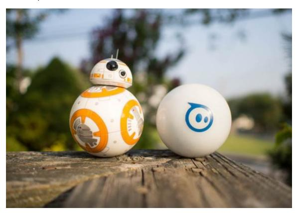
Se trata de un pequeño robot esférico del tamaño de una pelota de tenis, controlado de forma inalámbrica desde cualquier dispositivo móvil con iOs o Android a través de Bluetooth en una distancia de hasta unos 12 metros. Tiene una aplicación de control que permite conducirla en cualquier superficie, incluso en el agua.
