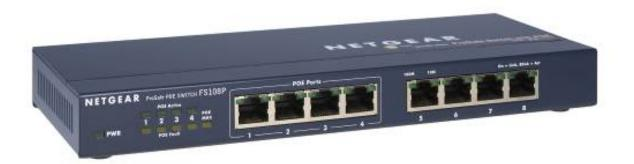
En mi caso tengo, y sirviendo de ejemplo, tengo conectado en los puertos POE un teléfono IP Linksys SPA922, una cámara IP AXIS 212PTZ y una cámara IP LINKSYS PVC2300. En los puertos que no son POE tengo conectado un punto de acceso Netgear WG602, que hace las veces de Cliente AP WiFi y el PC que tengo a bordo.
