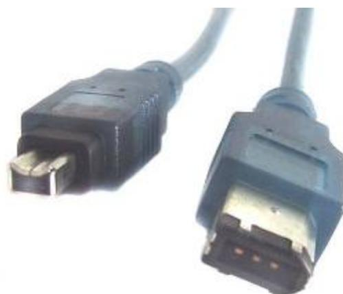
*El puerto IEEE 1394 (conocido como FireWire por Apple Inc. y como i.Link por Sony) es un estándar multiplataforma para entrada/salida de datos en serie a gran velocidad. Suele utilizarse para la interconexión de dispositivos digitales como cámaras digitales y videocámaras a computadoras.*
