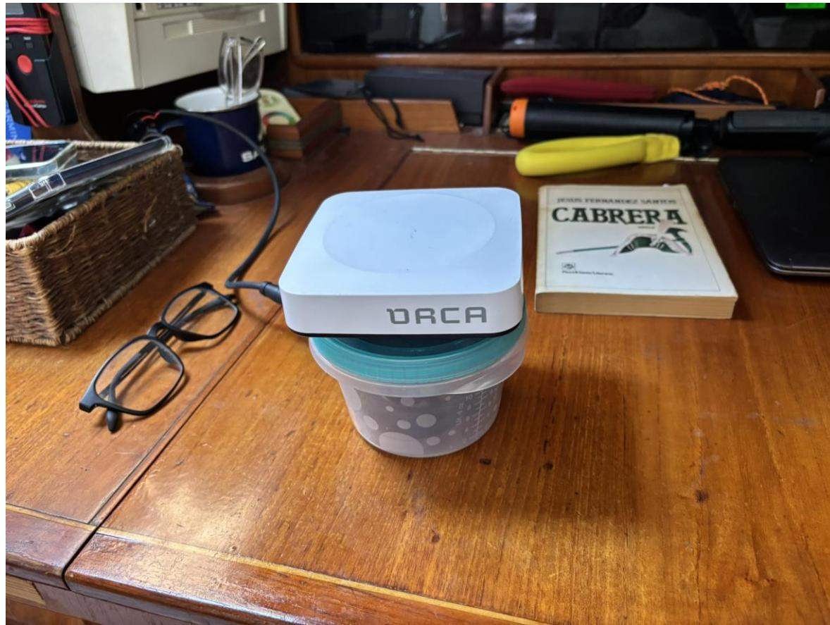
En mi caso, para usar este equipo, hice una instalación básica y sencilla, instalando el CORE a una base provisional, y conectando el conector a la red NMEA 2000. Y no requiere hacer nada más. Desde ese momento, el sistema empieza a captar todos los datos que emiten en dicha red y los deja a disposición del DISPLAY.
