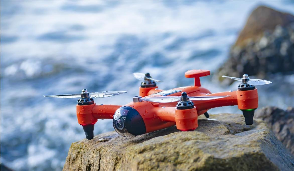
Este dron compacto e impermeable está pensado para el sector náutico. Alcanza la velocidad de 70 Km/h. Tiene localizador GPS-GLONASS y una autonomía de 16 minutos de vuelo, controlable a una distancia de 800 metros. El nuevo dron de Swellpro es el único dron cuadricóptero capaz de sumergirse debajo del agua, flotar como un barco, despegar desde el agua y ponerse a volar y grabar.
