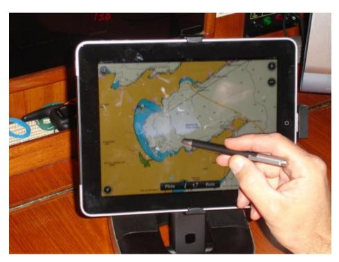
Este equipo, compatible con los modelos iPad e iPad2, nos permite tener la tableta bien sujeta a bordo, ya sea en horizontal o vertical. Es un accesorio que ejerce de cargador y de altavoz, de forma que además de soporte nos aporta estas dos funciones adicionales. Podemos ajustar el ángulo de visión vertical y horizontal.
